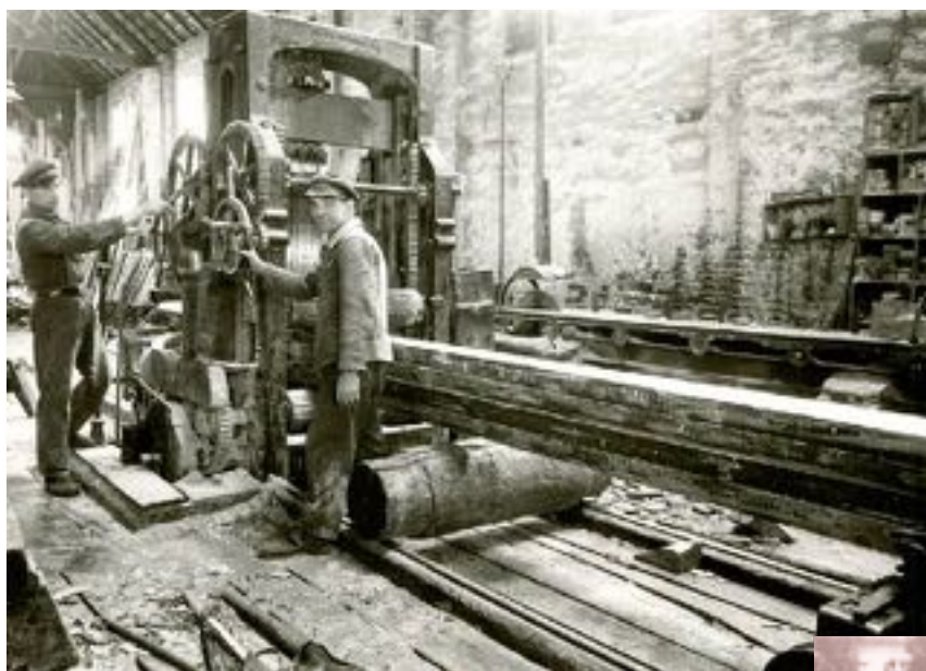
Vollgatter in der Sägehalle in den 1940er Jahren.
